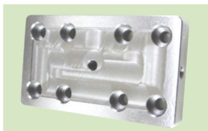
宽型液静压滑块 负荷:1800kg 线速:15M/min 刚性:230kg/um
